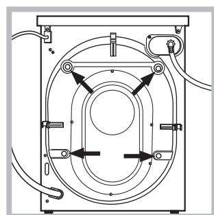
3. Видаліть запобіжні гвинти для транспортування та прокладку з відповідною розпірною деталлю, які знаходяться позаду (див. малюнок).
