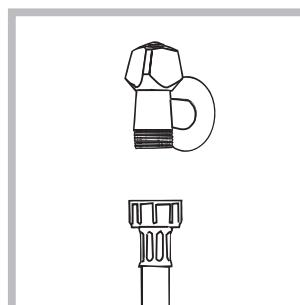
1. Підключіти живильний трубопровід, прикрутивши його до крану холодної води за допомогою штуцера з газовою різьбою 3/4 (див. малюнок). Перед підключенням спустіть воду, доки вона не стане прозорою.
