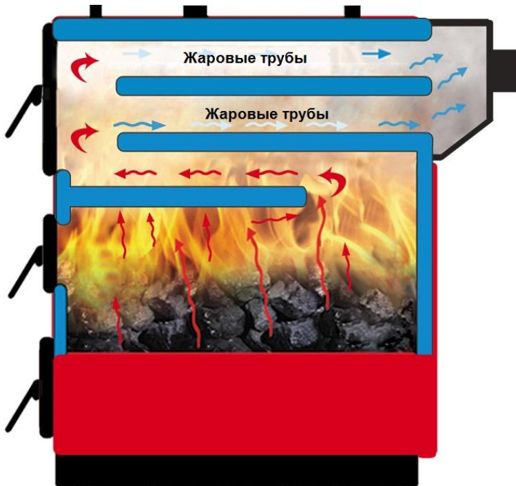
Рисунок 3 – Котел RK3G 20-100, схема движения дымовых газов.
