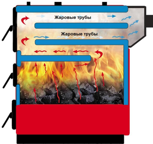
Рисунок 5 – Котел RK3G 20-100, схема движения дымовых газов.
