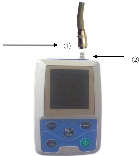
Рисунок 1.3.1 Верхній зовнішній повітропровід
