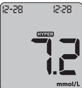
Щоб змінити значення оповіщення HYPO (або вимкнути), натисніть кнопку "<" або ">", а потім кнопку "M", щоб зберегти налаштування. Далі змініть значення оповіщення по гіпер-значенню (або вимкніть), натиснувши кнопки "<" або ">", а потім кнопку "M", щоб зберегти налаштування. Система перейде в режим налаштування попередження про необхідність перевірки вмісту кетонів.
