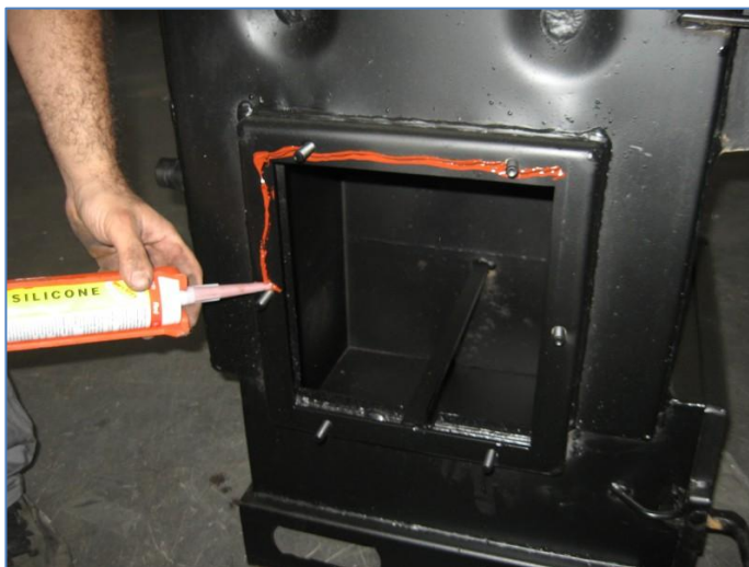
Малюнок 29. Нанесення жаростійкого силікону перед встановленням прокладки.
