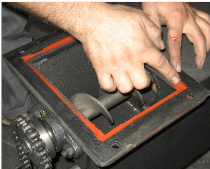
Малюнок 32. Встановлення прокладки між бункером і корпусом шнекової подачі.
