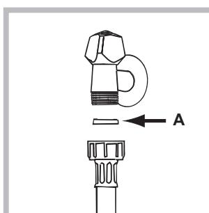
1. Вставте прокладку А у кінець труби для подачі води та вкрутіть його у кран з холодною водою за допомогою патрубка з різьбою 3/4 (див. малюнок). Перед підключеннем спустіть воду, доки вона не стане прозорою.
