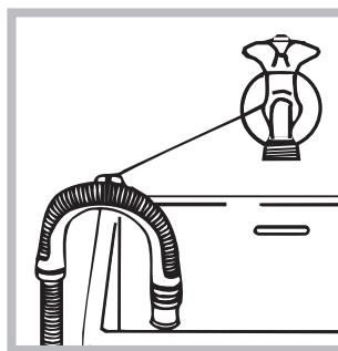
Расположение сливного шланга должно обеспечивать разрыв струи при сливе (конец шланга не должен быть опущен в воду). В случае крепления на край ванной или раковины, шланг вешается с помощью направляющей (входит в комплект поставки), которая крепится к крану (рис.).
